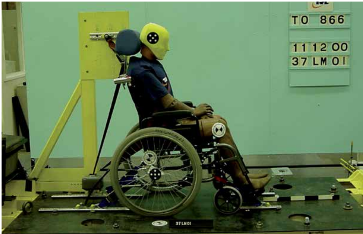
Silla de ruedas sujeta a los raíles, antes del impacto
