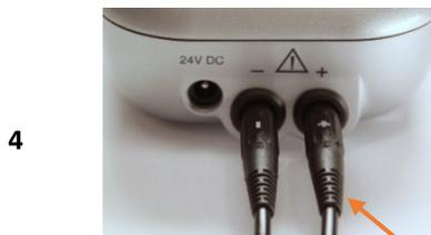
En el lado exterior izquierdo del **idromed® 5 PS** se encuentran las tomas de contacto para los cables de los electrodos.
