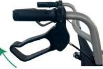
Imagen 1. Para frenar momentáneamente la silla, presione ligeramente el freno. Para avanzar, deje de presionar el freno.
