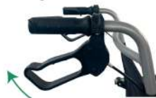
Abbildung 1. Um den Stuhl kurzzeitig abzubremsen, drücken Sie leicht auf die Bremse. Um sich vorwärts zu bewegen, lösen Sie die Bremse.
