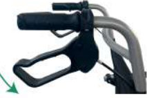
Imagen 2. Para activar el sistema de bloqueo presione el freno hacia abajo. Para desbloquearlo, eleve los frenos hacia arriba y podrá continuar avanzando.
