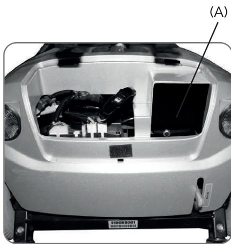
Ladda batterierna efter varje användning. Kontrollera batteriindikatorn innan du använder skotern igen. Om skotern inte används under en längre tid kan batterierna laddas ur. Kom ihåg att ladda batterierna minst en gång i månaden.
