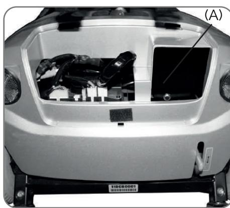
Laad de batterijen na elk gebruik op. Controleer de accu-indicator voordat u de scooter weer gebruikt. Als de scooter een tijd niet wordt gebruikt, kunnen de accu's leeg raken. Vergeet niet de batterijen minstens één keer per maand op te laden.
