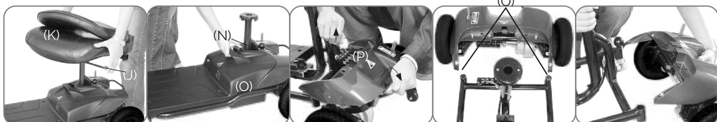
4. Aby złożyć układ kierowniczy, podnieś dźwignię (I), aby przechylić układ kierowniczy do najniższej pozycji i złóż kolumnę, jak pokazano na poniższym rysunku.
