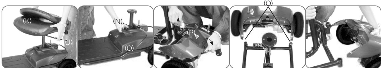
4. Para dobrar a direção, levante a alavanca (I) para inclinar a direção até a posição mais baixa e dobre a coluna tal e como se mostra na seguinte imagem.
