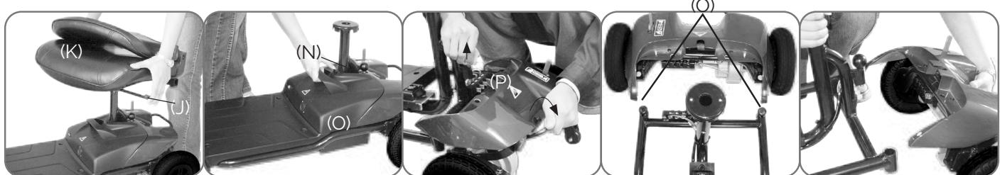
4. Para plegar la dirección, levante la palanca (I) para inclinar la dirección hasta la posición más baja y doble la columna tal y como se muestra en la siguiente imagen.
