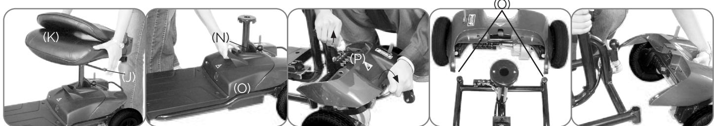
4. Per ripiegare lo sterzo, sollevare la leva (I) per inclinare lo sterzo nella posizione più bassa e piagare la colonna come mostrato nella figura seguente.
