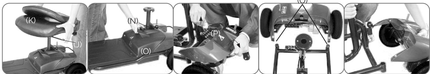
4. Om het stuur in te klappen, tilt u de hendel (I) op om het stuur in de laagste stand te kantelen en klap u de stuurkolom in zoals aangegeven in de onderstaande afbeelding. zoals te zien is op de foto hieronder.
