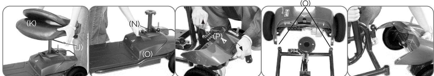
4. Um die Lenkung zu klappen, heben Sie den Hebel (I) in die unterste Position und klappen Sie ihn wie auf dem folgenden Bild gezeigt zusammen.
