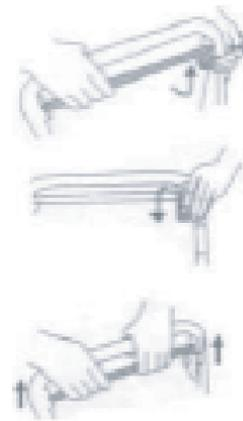
**ES** Ajuste del freno / **EN** Brake adjustment / **FR** Réglage des freins / **IT** Regolazione dei freni / **DE** Einstellung der Bremse / **PT** Regulação dos travões / **NL** Rem afstellen / **SWE** Justering av bromsar / **PL** Regulacja hamulca / **DK** Justering af bremsen
